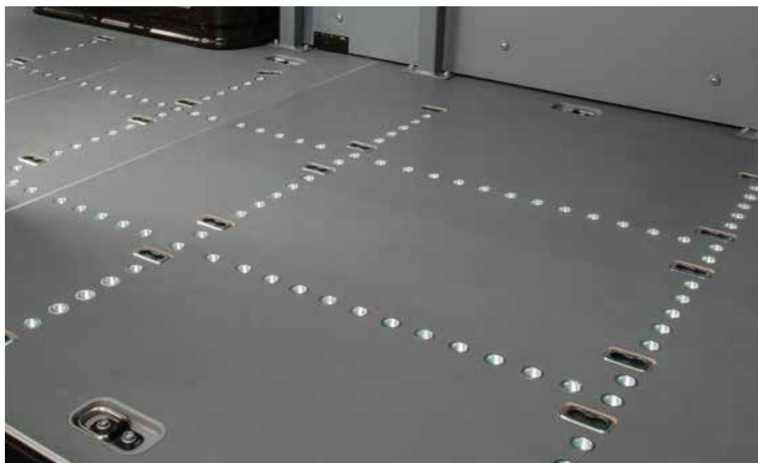
SAFETY CROSS: punti di fissaggio longitudinali e trasversali su richiesta SAFETY CROSS: points de fixation longitudinaux et transversaux sur demande
